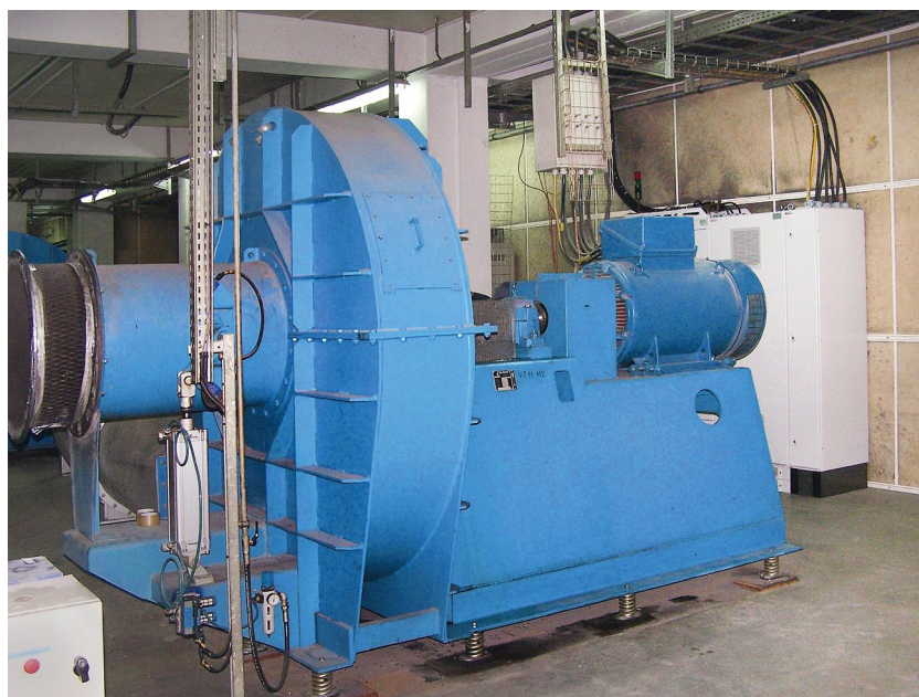
Wentylator 400kW – produkcja szyb samochodowych
