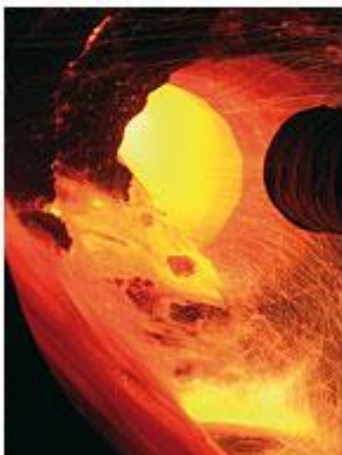
Rys. 3 Wnętrze pieca przewalowego
