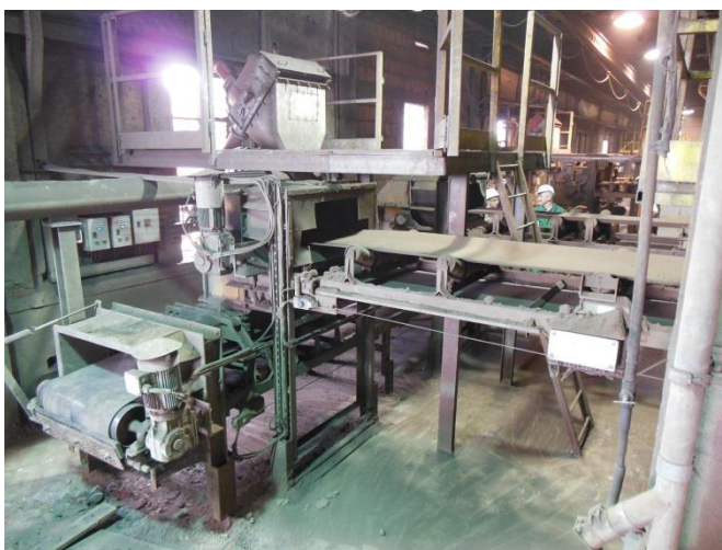
Rys. 1 Układ wsadowania pieca przewalowego.
