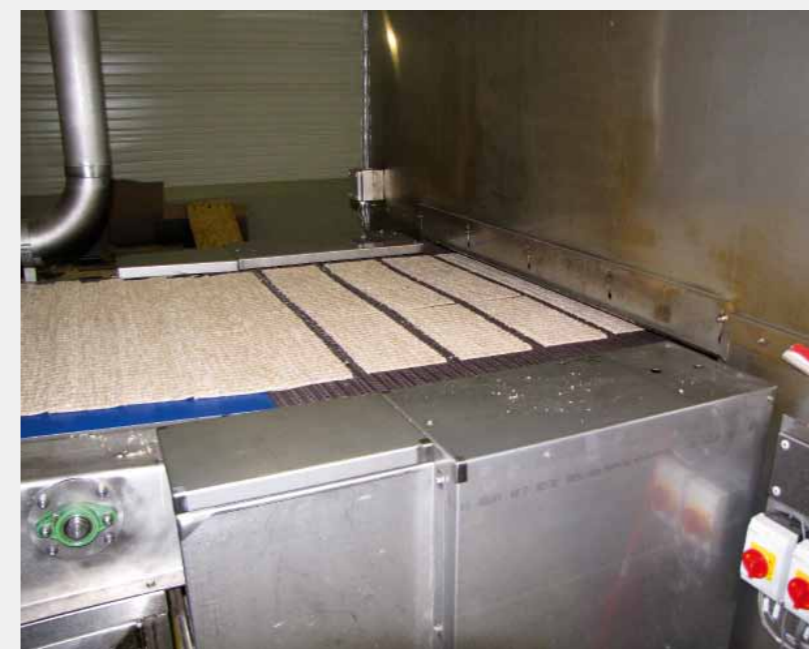
Rys. 4. Proces cięcia masy na paski
